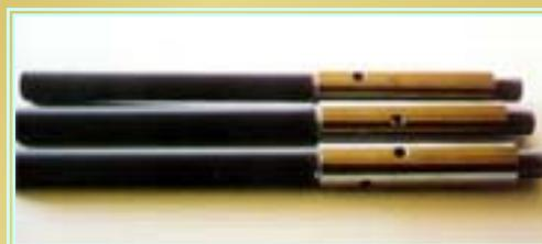
プラズマ溶射  $Cr_2O_3:SiO_2$  HRC70
