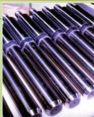
ガスフレイム溶射 自溶性合金 HRC61
