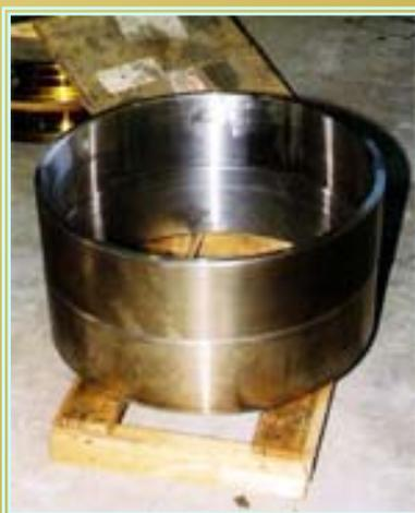
ガスフレイム溶射 自溶性合金(WC) HRC70
